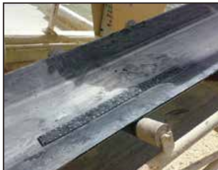
Longitudinal rip repair
